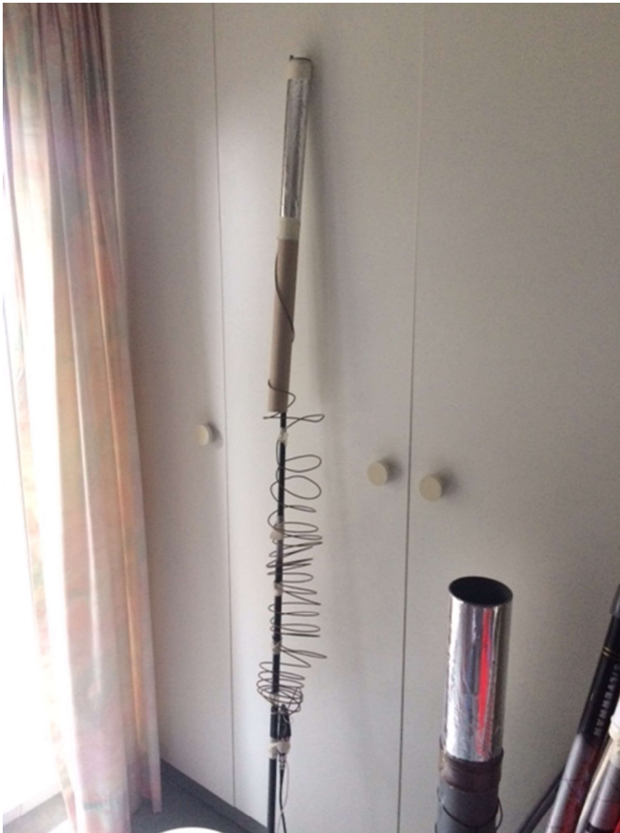
Abbildung 2 EH 40m als halber Dipol in Leichtbauweise Typ „Murx“
