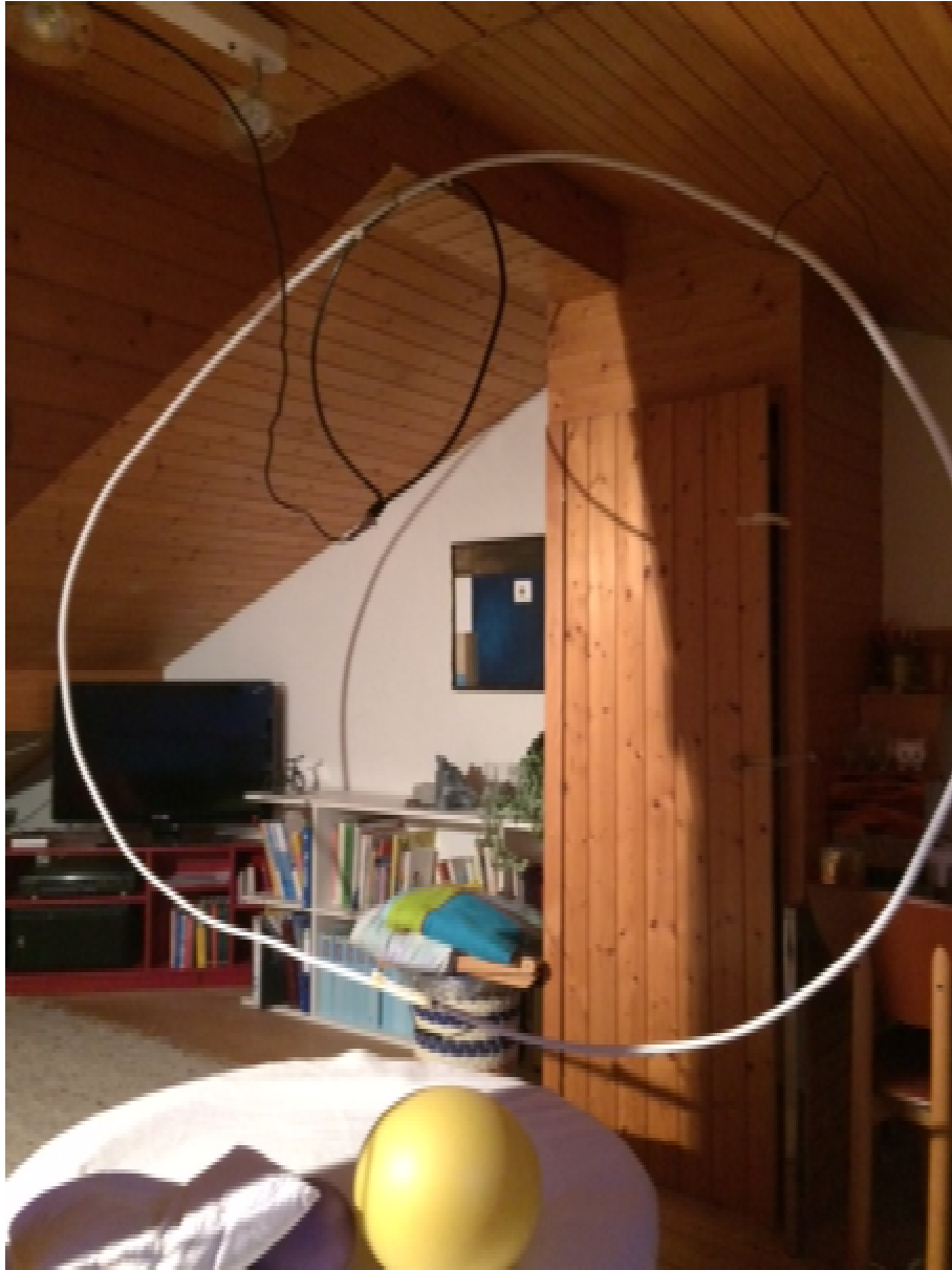
Abbildung 9 20m M.L mit Mehrschichtverbundrohr und der leicht grösseren C.L.
