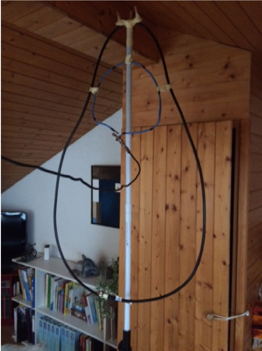
Abbildung 3 6.4m lange Loop mit RG 213 Koaxkabel mit ca. 15 cm Koaxkabel Überlappung
