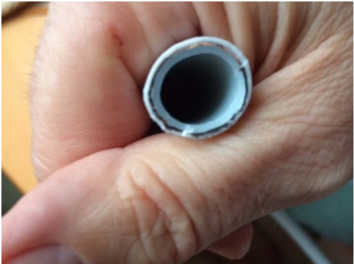
Abbildung 6 Mehrschichtverbundrohr 12/16 mm, 95°C, 10 bar
