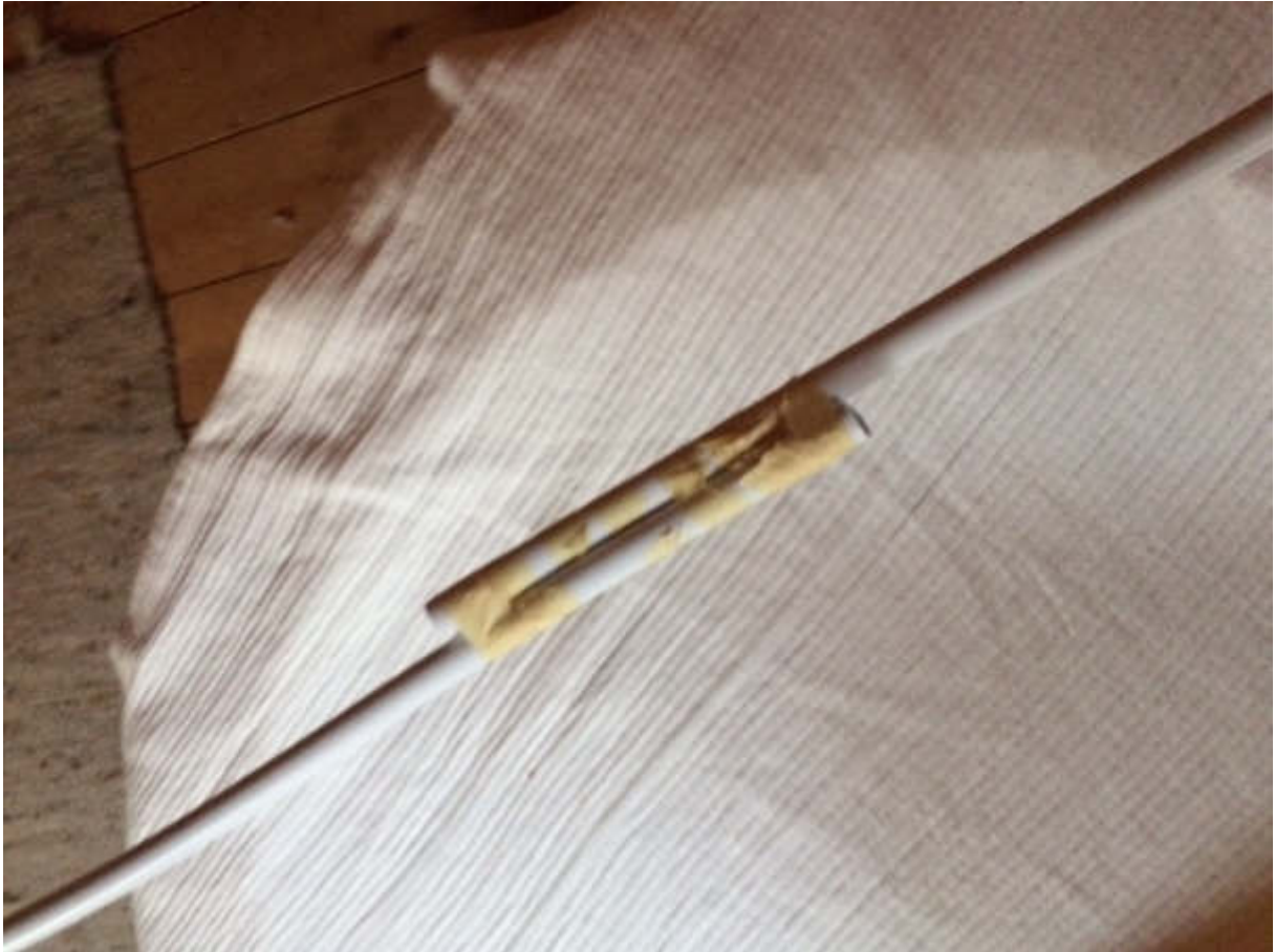
Abbildung 8 20m M.L. mit dem Mehrschichtverbundrohr und ca. 15 cm Überlappung
