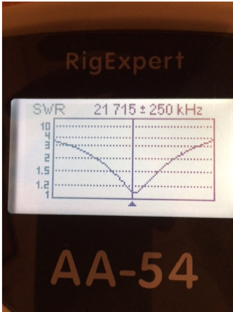
Abbildung 2 SWR der 15m Loop
