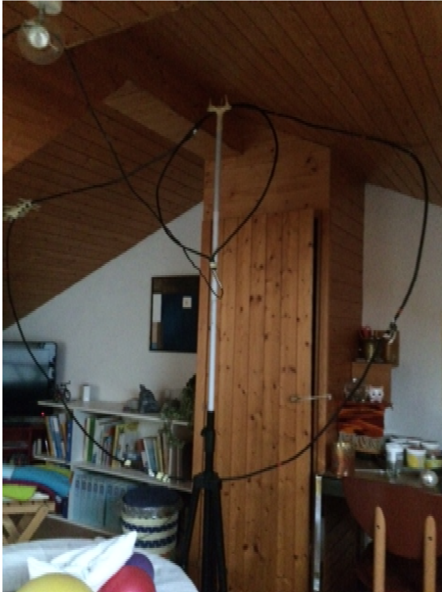
Abbildung 4 M.L. 20m möglichst rund aufgehängt an Haken rts und lks an das Täfer geklebt
