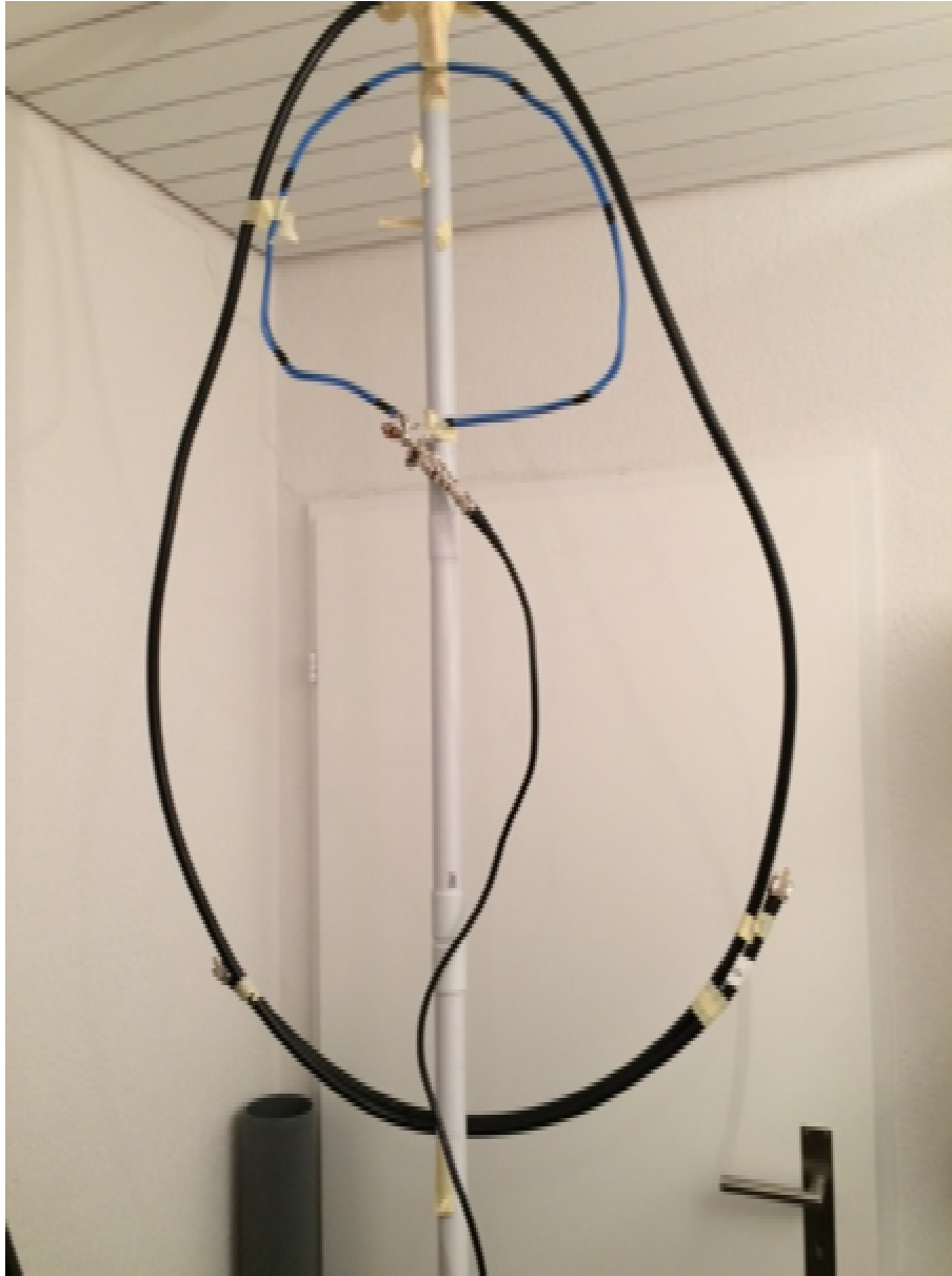
Abbildung 1 15m Loop mit 2m RG 213 Koaxkabel
